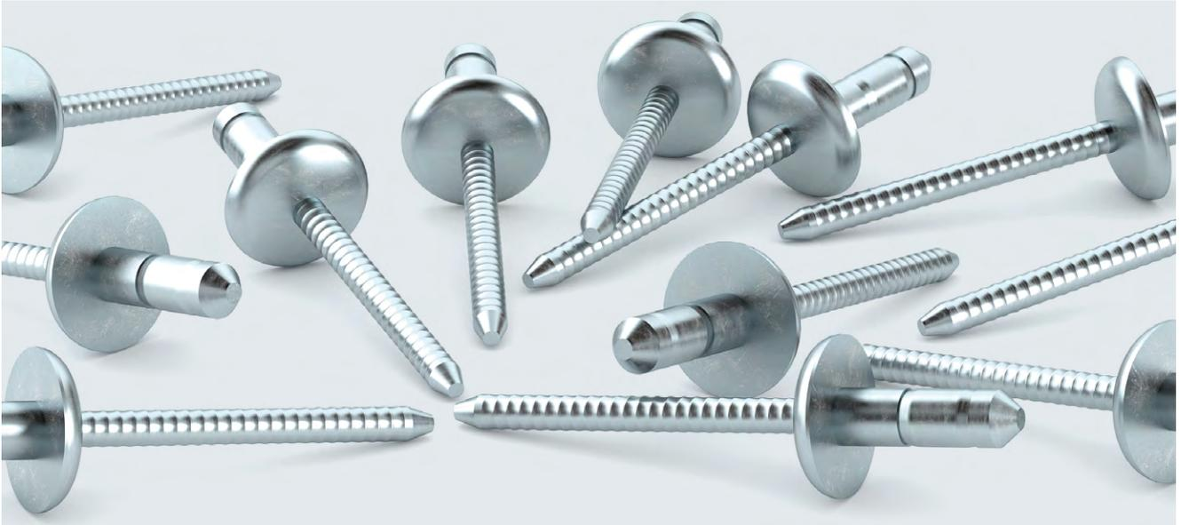
Durch die Kombination von konstant großer Schließkopfauflage, Vibrationssicherheit und teilweise mittragendem sowie festsitzendem Restnietdorn eignet sich der TIFAS® Grip Blindniet für dünne Bauteile die hohen Belastungen standhalten. Durch Lochleibung können Bohrlochtoleranzen ausgeglichen werden.
